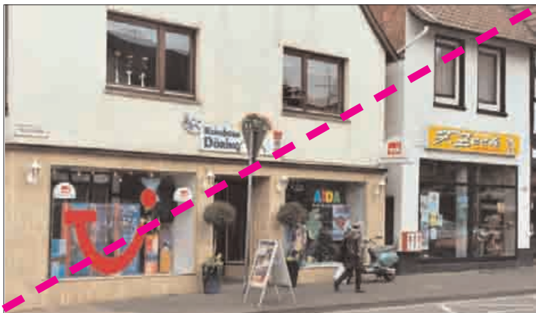
Unterschiedliche Fensterformate und -gestaltung, Zerteilung der Fassade, Überfrachtung mit Werbeanlagen.
